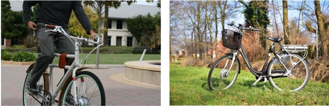
Figure 2 : Exemple de vélos électriques européens, type BSEB. Sur l'image de gauche, le moteur est dans la roue avant et la batterie dans le tube du cadre.
